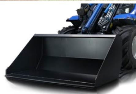
Le benne MultiOne sono costruite in solido acciaio e hanno un design semplice che assicura un'ottima visibilità dell'area di lavoro. Tutti i modelli sono predisposti di fori lungo il profilo per l'installazione di denti da scavo. Internamente sono presenti dei rinforzi per aumentare la robustezza e sul fondo sono dotate di pattini per diminuire l'usura. La lunghezza della benna è ottimizzata per ottenere la massima forza di strappo.
