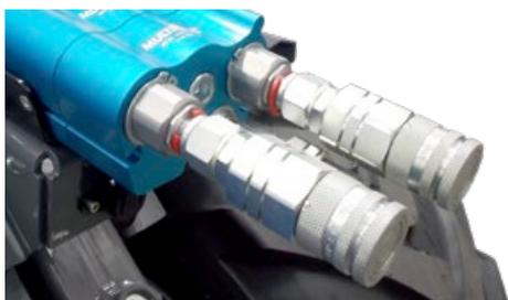
Adattatore a tre vie da applicare al multiconnettore della macchina per poter collegare attrezzature dotate di attacchi rapidi standard. E' consigliato per accessori con cilindri idraulici, mentre non è indicato per accessori con motori idraulici.
